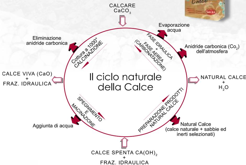
Con la cottura in forni verticali a temperature di circa  $1000^\circ\text{C}$ , la cosiddetta "calcinazione", il calcare (carbonato di calcio,  $\text{CaCO}_3$ ) viene trasformato in Ossido di Calcio e Anidride Carbonica. L'ossido di Calcio così ottenuto è la calce viva.
