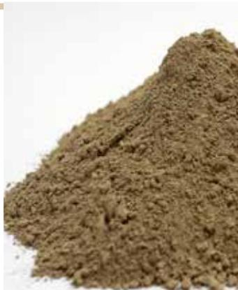
Legante idraulico con fase aerea completamente naturale, ottenuto con la cottura in forni verticali e con temperature inferiori ai 1000°C di calcari marnosi, senza l'aggiunta di alcun elemento correttivo.
