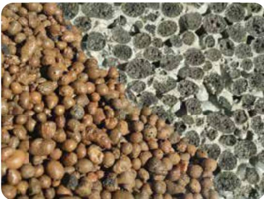
Il fuoco modella e forgia l'argilla cruda all'interno di un forno rotante, l'elevata temperatura innesca dinamiche chimiche che portano ad un aumento di volume del granulo, e la creazione del nucleo poroso. La parziale liquefazione ed il moto rotatorio danno luogo alla formazione di sferoidi o granuli già parzialmente formati.
