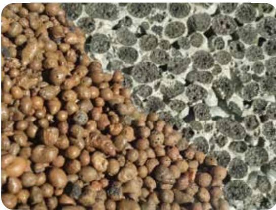
la sua natura intrinseca non l'avrebbe. Il fuoco modella e forgia l'argilla cruda all'interno di un forno rotante, l'elevata temperatura innesca dinamiche chimiche che portano ad un aumento di volume del granulo, e la creazione del nucleo poroso. La parziale liquefazione ed il moto rotatorio danno luogo alla formazione di sferoidi o granuli già parzialmente formati.
